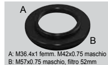
A: M42x1 maschio M36.4x1 femm. B: M57x0.75 maschio, filtro 52mm
